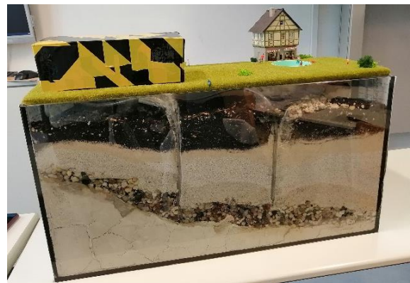
3D-Querschnitts-Modell einer Geothermieanlage zur Veranschaulichung für die Schülerinnen
