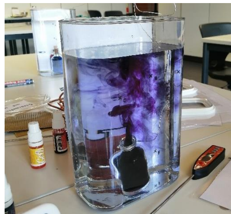
Experiment zur Konvektion bei der Station Wärmetransport des TUM Entdeckerinnen Projekttages
